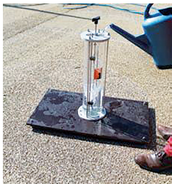
Mesure de perméabilité sur le terrain à l'aide d'un perméamètre (© CIMBETON référence Guide T69)
