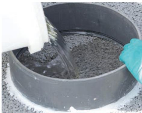
Protocole de mesure in situ (ASTM C1701 – © CIMBETON référence Guide T69)
